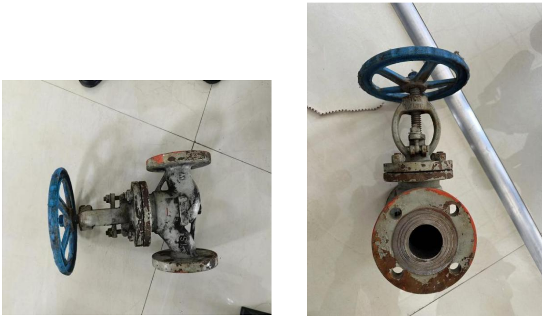
图 10-11 内漏的手动截止阀
